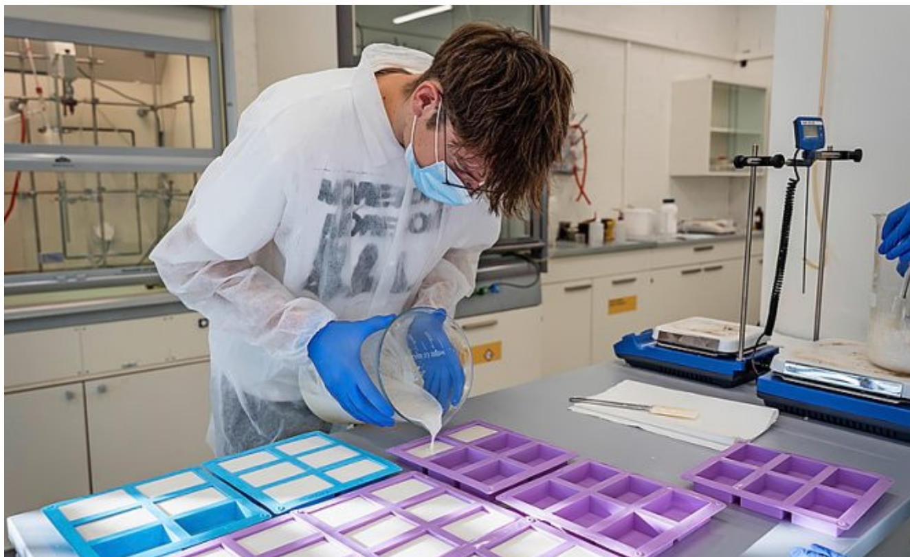
Die Produkte werden in silikonformen gegossen. 20min/Matthias Spicher
